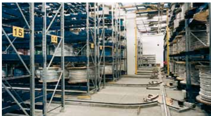
Устройства для обслуживания стеллажей, способные перемещаться по кривой
