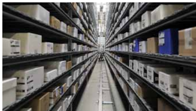
Papstar, складирование груза на сплошных полках
