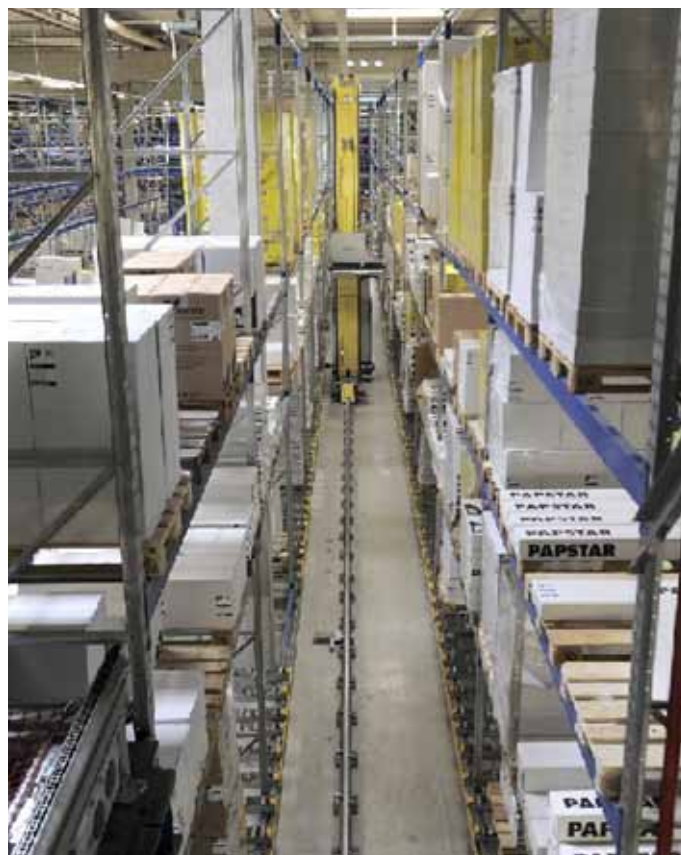
Papstar, складирование паллет. На самом нижнем уровне паллеты загружаются в гравитационные каналы для их последующей подачи в зону коммисионирования.
